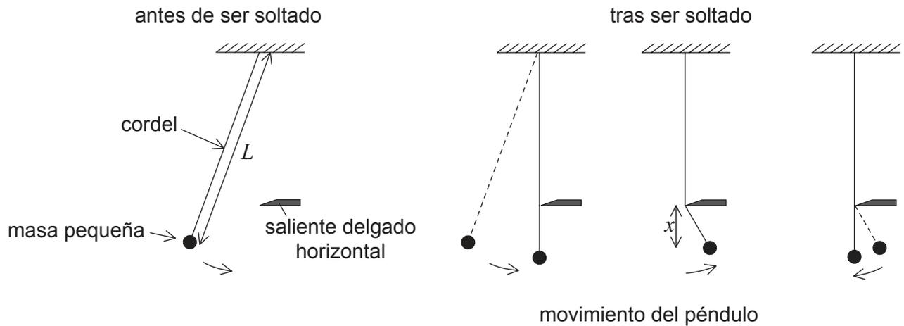
La longitud  $L$  del cordel se mantiene constante durante el experimento. Se modifica la posición vertical del saliente delgado y horizontal para cambiar  $x$ .
